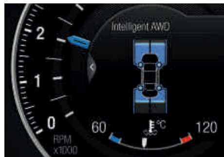
Un affichage spécifique indique la répartition de la transmission entre les quatre roues. (de série sur les versions Intelligent AWD)
