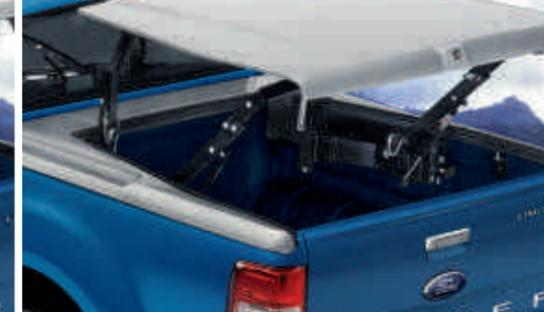
Peut également être verrouillé en position relevée pour le transport d'objets encombrants.
